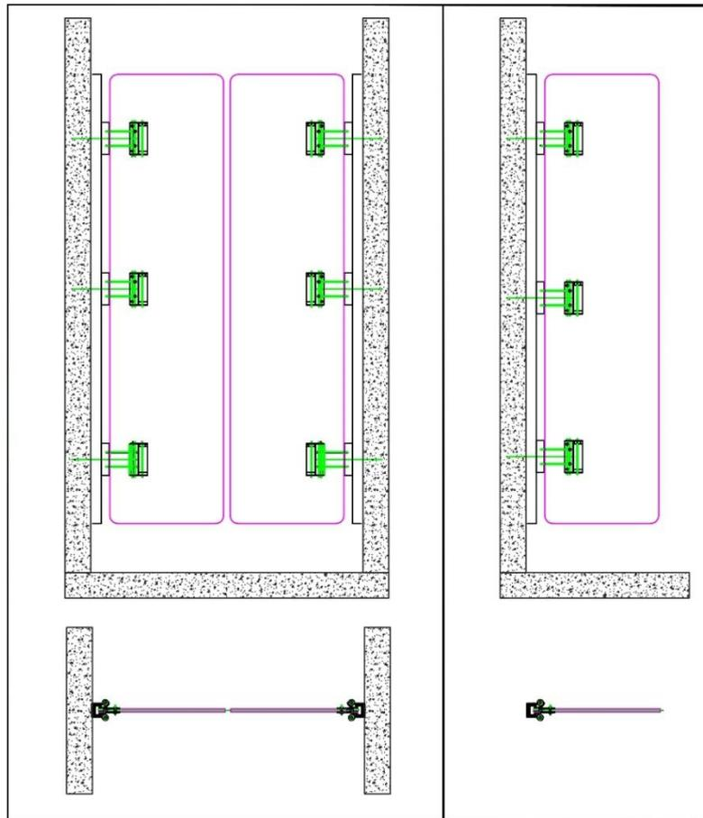
MONTAGE CHARNIERE DOUBLE ACTION ( 065017/ 639) FIXATION SUR MUR
